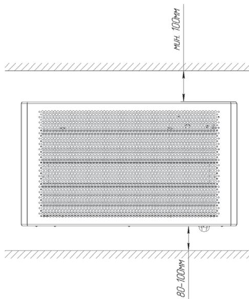
Рисунок 3 – Схема размещения электрообогревателя на стене
