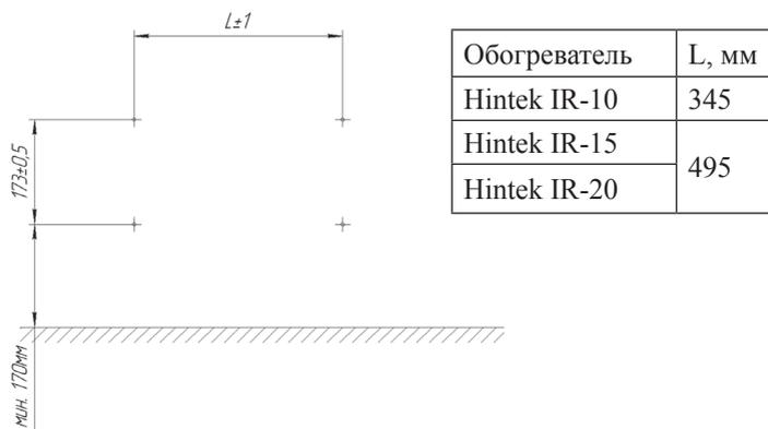
Рисунок 4 - Разметка отверстий для навеса обогревателя.
